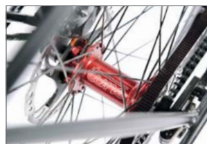
Die breite Singlespeed-Nabe ergibt ein sehr steifes Hinterrad.
