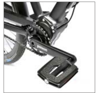
Aufgeräumt, tretlagernah: die Pinion-Schaltung, prima Pedale.
