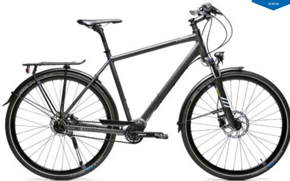
Aufgeräumt, tretlagernah: die Pinion-Schaltung, prima Pedale.
