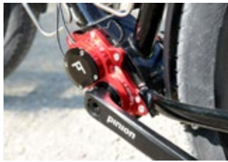
Geschmiedet und geätzt: die hochwertige Pinion-Brücke.
