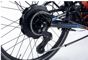
Neodrive Motor: kultiviert, extrem leise, kann rekuperieren.
