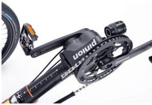
Schaltung: Pinion 12fach, skalierter Ausleger (Anpassung Größe).
