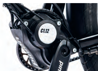
Zwölf Gänge im Ölbad: die Pinion C1.12-Getriebschaltung.
