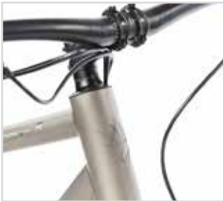
Das 12-Gang-Getriebe unter geschmiedeter Titan-Brücke. Unten: Leitung und Züge sind quasi komplett innen geführt.
